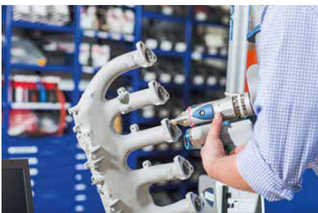
Bauteile werden mit dem Scanner erfasst und mit Reverse Engineering wieder verfügbar gemacht.
