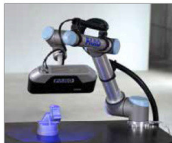
Scanvorgang. Der empfindliche 3D-Scanner nimmt Objekte sowie deren Umgebung aus unterschiedlichen Winkeln wahr und erkennt verschiedene Farben.
